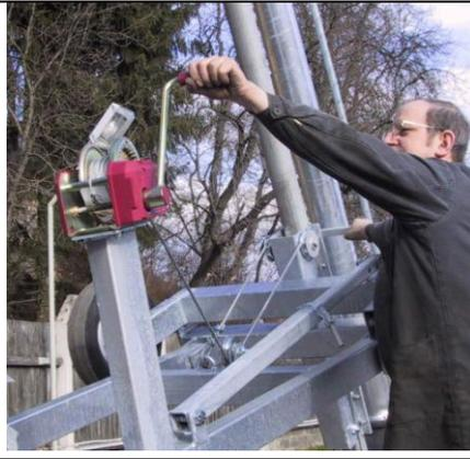
Die Pumpe nun langsam mittels Seilwinde abschwenken und durch Anheben des Arretierhebels auch absenken.
