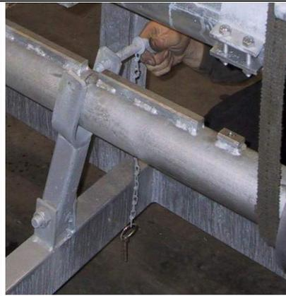
Die Pumpe mit dem Antriebsrohr nach unten in die Halterung des Hubgestells einlegen.
