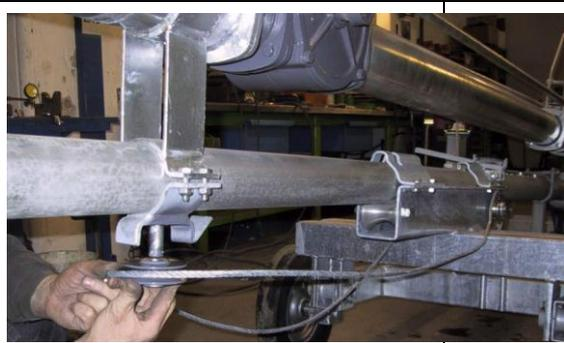
Die Seilrolle vom Antriebsrohr der Pumpe abnehmen (Splint entfernen)
