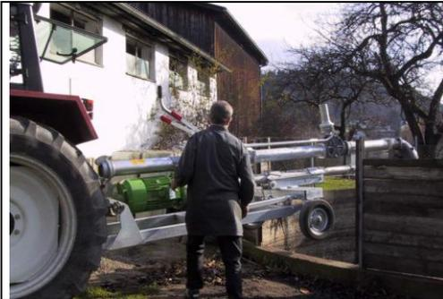
Mit der Pumpe rückwärts an die Grube / Grubenöffnung heranfahren
