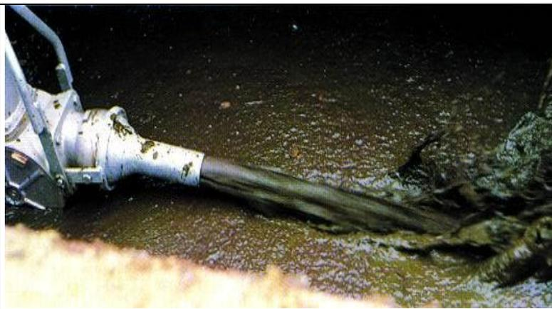
Die Pumpe so weit absenken, bis die Rührdüse in die Schwimmdecke eintaucht.
