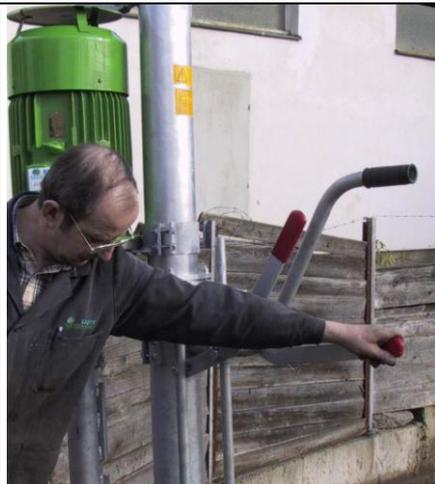
Die Rührvorrichtung ist mit drei Hebel ausgestattet.
