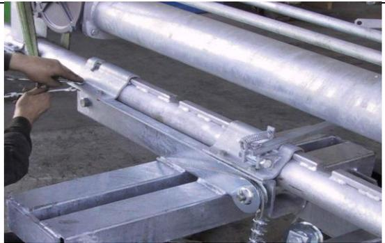
Die Führungsschelle(n) mit dem Arretierhebel wieder montieren
