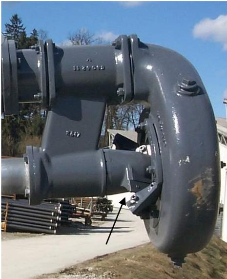
Die Schneiden der Messer sind zu überprüfen. Sie sind durch ihre Konstruktion vierfach verwendbar, bevor sie nachgeschliffen werden müssen.
